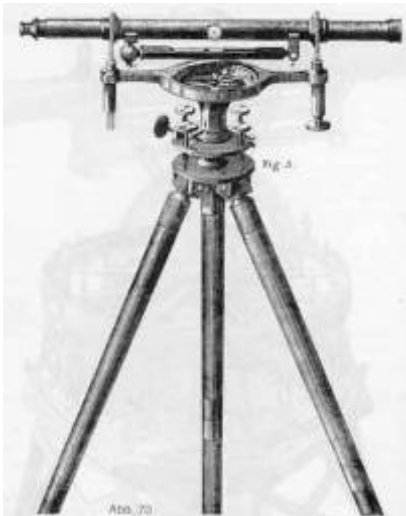
Abb. 11 Nivellier (Weingeistwaage) auf Stativ, ca. 1790 (Adams, Abb. 70, S. 164)
