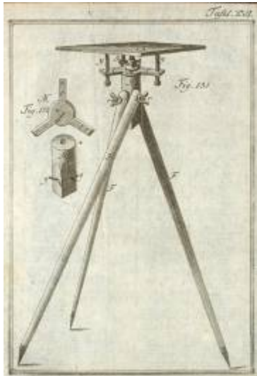
Abb. 5 Meßtisch (Tempelhof, 1790, Tafel XVI): Die Meßtischplatte kann über dem Korpus horizontal gedreht und über die Kugel sowie drei hölzerne Schrauben horizontalisiert werden. Die drei starren Beine werden von dem Korpus ausgeschwenkt und mit den Flügelschrauben fixiert. Die gesamte Höhe beträgt ca. 140cm.
