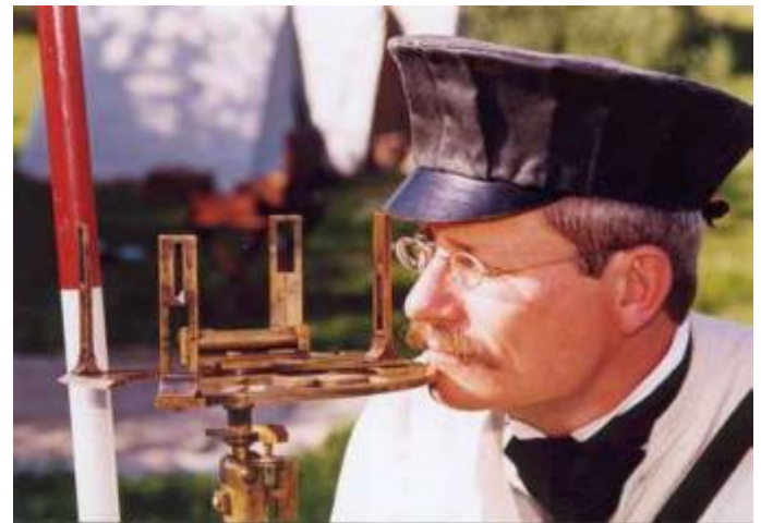
Abb. 8 Bei Bauarbeiten wurden Winkel mit Hilfe zum Beispiel mit Hilfe eines Graphometers (Halbkreisinstrument, hier 1. Hälfte des 19. Jahrhunderts) gemessen. Im einfachsten Fall, wie hier, war auf der Grundplatte eine Alhidade (Zeigerarm) montiert, mit das Objekt über einen Schlitz und ein Fadenkreuz aus Rohßhaar angepeilt wurde. Unter Platte sind Arretierschraube für die horizontale Drehung der Platte und das Kugelgelenk für die Horizontierung gut zu erkennen.
