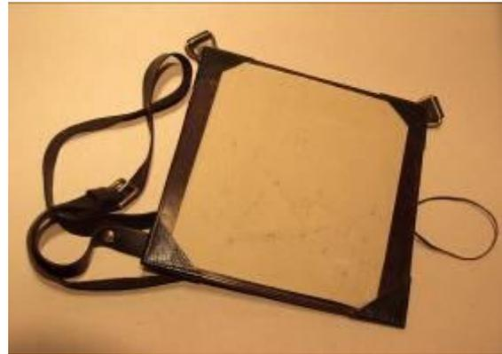
Abbildung 5: Planchet zum Krokieren nach Decker, welches über die Schulter gehängt wird. Darauf ist der Entwurf eines Dreiecksnetzes für die Triangulation zu sehen (Reproduktion des Autors).
