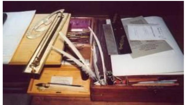
Abbildung 54: Kleines Feldbureau mit Zeichenutensilien; zu sehen sind ein Magazinbesteck, Tuschkasten, Kurvenlineal, Rolllineal, Zeichenbrett, Skripturkasten, Schreibfedern, Pinsel, Siegellack, Transversalmaßstab, Papier, Parallellineal und Instruktionen. (Rekonstruktion des Autors, © Uwe Feuerbach).
