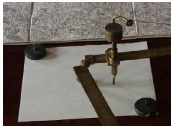
Abbildung 35: Der gleiche Pantograph wie oben. Der mit einem Bleigewicht beschwerte Stift kann über einen Faden, der zum Zeigerarm auf der Kopiervorlage führt, auf- und abgesenkt werden. Vorlage und Kopie werden durch Bleigewichte in Position gehalten.
