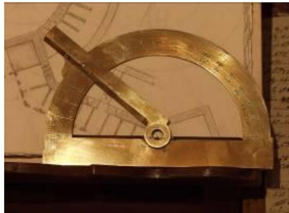
Abbildung 23: Protraktor mit Zeigerarm, der einen Vernier mit 5 Minuten-Einteilung enthält, so daß die Winkel theoretisch sehr viel genauer als mit dem Transporteur abgegriffen oder gezeichnet werden können (19. Jahrhundert)
