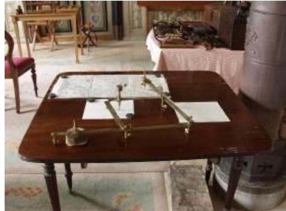
Abbildung 34: Aufgebauter Pantograph (ca. 1850) zur Reduktion einer Karte.
