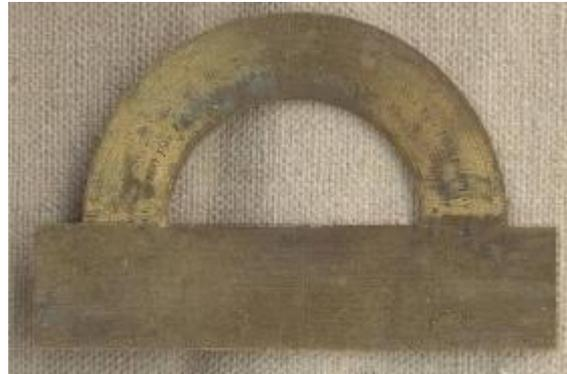
Abbildung 22: Einfacher Transporteur aus Messing mit 180°-Einteilung, je 1/2 Grad genau (Wien, ca. 1800). Eine größere Genauigkeit kann mit einem größeren Halbkreis oder dem Protraktor (siehe folgende Abbildung) erreicht werden.
