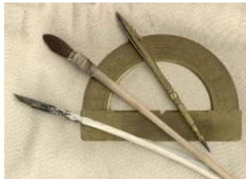
Abbildung 9: Transporteur (s.u.), darauf liegend eine Reißfeder mit Federmesser an der Spitze, ein Tuschpinsel und eine Gänsekielfeder mit dem typischen doppeltgeschwungenem Profil.
