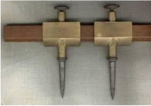
Abbildung 14: Stangenzirkel, hier die beiden Spitzen aufgesteckt auf eine ca. 1m lange Hartholzstange, Mahagoni (19. Jahrhundert). Stangenzirkel wurden zum Kopieren von Plänen oder Übertragen genauer Längen für großformatige Pläne oder Karten benutzt.
