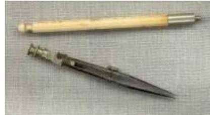
Abbildung 28: Punktier- oder Kopyiernadel mit abgeschraubter Reißfeder (wohl englisch, 2. Hälfte des 19. Jahrhunderts)
