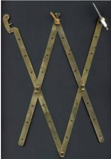
Abbildung 32: Kleiner (Taschen)Pantograph aus Messing für den Feldgebrauch (ca. 1800), eingestellt auf eine Reduktion 1:2; von oben links nach rechts: Abtaster für die Vorlage, Stift für die Kopie, Fixierung des Drehpunkts mit einem Nagel auf dem Zeichenbrett. Die Bohrungen in den Schenkeln erlauben das Umsetzen der Gelenke auf andere ganzzahlige Seitenverhältnisse. Damit sind Kopien eines Blatts im DIN A4 bei geringer Genauigkeit möglich, denn die Kopie muß immer nachgezogen werden.
