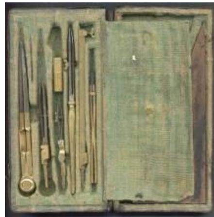
Abbildung 12: Kleines Magazinbesteck, mit grünem Samt ausgeschlagen, von links nach rechts: Stechzirkel, 2 Reißfedern als Einsatz für Stückzirkel, darüber Köcher für Minen, Reißfeder, Verlängerung für Stückzirkel, Porte Crayon mit eingesetzter Kohle. Der Stückzirkel selbst ist verloren gegangen (Brüder Vogtländer, Wien, ca. 1800).
