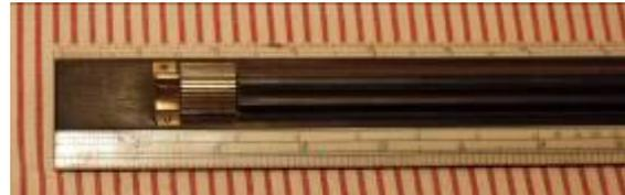
Abbildung 18: Rolllineal aus Ebenholz, Skala aus Knochen oder Elfenbein, Messing. (engl., 1. Hälfte des 19. Jahrhunderts, vermutlich zur Kursbestimmung in der Seefahrt eingesetzt)
