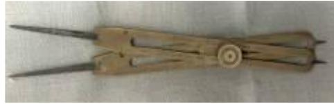
Abbildung 30: Reduktionszirkel, über die Stellschraube in der Mittel lassen sich die Verhältnisse der Schenkel über eine Skala einstellen, hier Flächen = Plains (englisch, ca. 1940)
