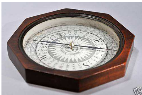
Abbildung 12: Taschenbusssole, engl. um 1800, für die Orientierung im Terrain. Alle anderen Boussoles, die auf ein Stativ oder einen Meßtisch montiert werden mußten, wären im Feld zu unhandlich gewesen.
