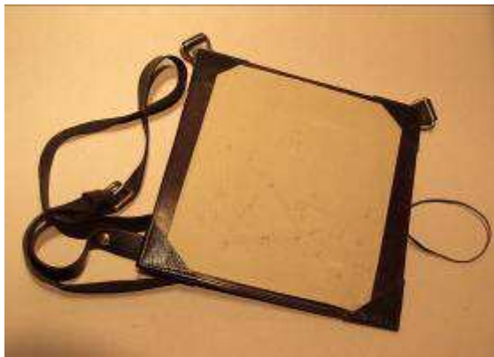
Abbildung 11: Planchet (auch: Campagnepplanchette) zum Krokieren nach Decker, militär. Aufnahmen, welches über die Schulter gehängt wird. Darauf ist der Entwurf eines Dreiecksnetzes für die Triangulation zu sehen (Reproduktion des Autors).
