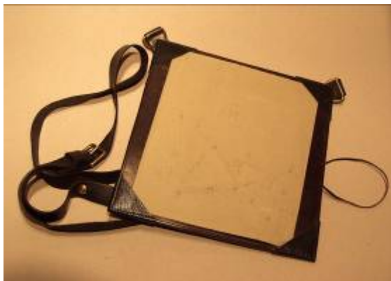
Abbildung 12: Planchet (auch: Campagneplanchette) zum Krokieren nach Decker, welches über die Schulter gehängt wird. Darauf ist der Entwurf eines Dreiecksnetzes für die Triangulation zu sehen (Reproduktion des Autors).
