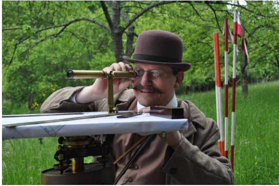
Abbildung 7: Nachgestellte Meßtischaufnahme am Anfang des 19. Jahrhunderts (Autor)
