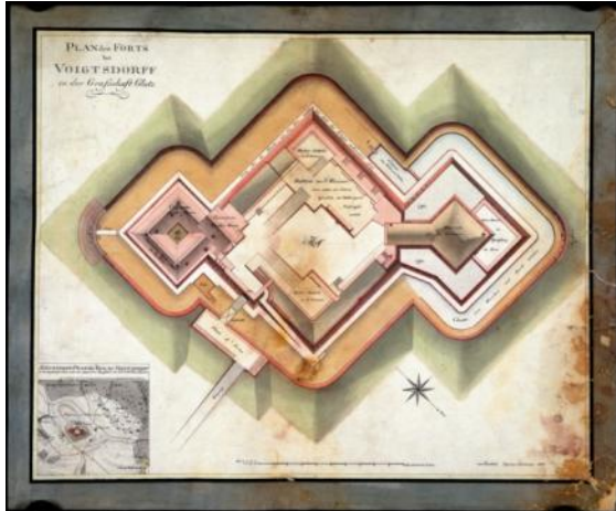
Abbildung 11: Fort Wilhelm bei Voigtsdorf in der Grafschaft Glatz, erbaut 1790 oder 1791, aufgegeben nach 1815. Aufgenommen 1803 von Ingenieurlieutenant v. Humbert. Die exponierten ausspringenden Winkel der beiden äußeren Bollwerke sind durch Reversgalerien geschützt. Die flache Bergkuppe begünstigt hier einen Entwurf ohne sonderliche Rücksicht auf das Terrain. (Stiftung preußischer Kulturbesitz)
