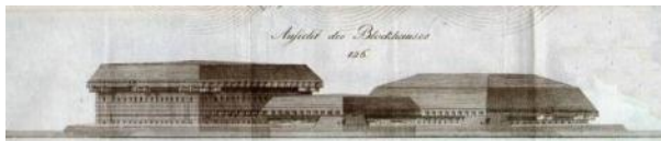
Abbildung 13: Ansicht des o.g. dreigliedrigen Blockhauses: links eine doppelstöckiges mit vorgelegten Kaponieren im Graben, in der Mitte ein einfaches mit Erdabdeckung gegen Wurffeuern, rechts ein einstockiges mit Schützenauftritt auf dem Banquet [Verdeck] (Reiche, Baupraktik, Tab. XII, Fig. 126)
