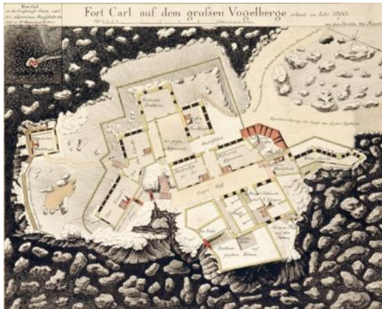
Abbildung 16: Fort Carl auf dem großen Vogelberge läßt wohl eher der polygonalen Manier zuordnen. Alle Kasematten und Wohnungen sind als Blockhäuser errichtet; nur der steinerne Koffer ist nicht in Holz und Erde gebaut. Der steil abfallende felsige Hang ist gut verdeutlicht.
