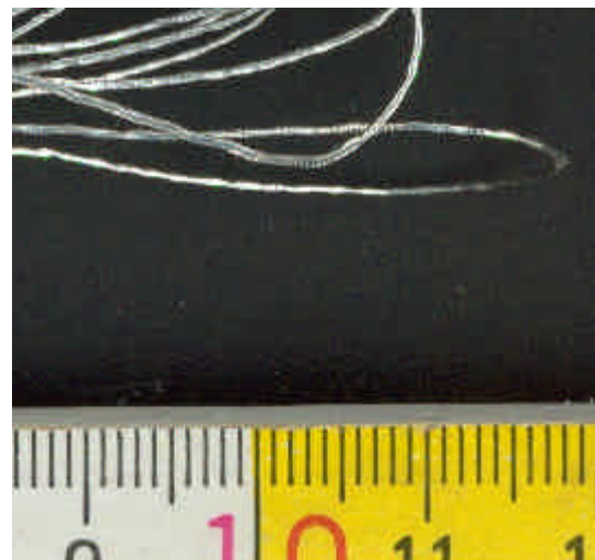
Abbildung 23: Materialprobe „real Silver“ für Stickerei Durchmesser des Lahn ca. 0,6 mm.
