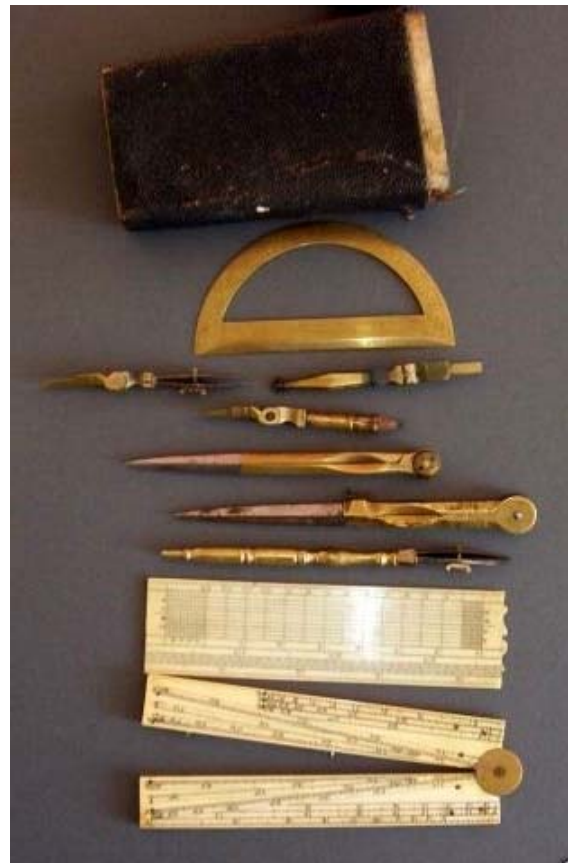
Abbildung 5: Inhalt eines englischen Taschenbestecks: Transporteur, Ziehfeder für Stückzirkel, Kopterrad, Bleistifteinsatz für Stückzirkel, Stechzirkel, Stückzirkel, Ziehfeder, Transversalmaßstab, Proportionalzirkel für einfache Überschlagsrechnungen (England, ca. 1800)
